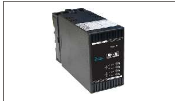
본변환기 SC-ASC는 AC전압이나 전류신호를 받아서 그에 비례한 절연된 DC신호를 출력하는 제품입니다. ( 용도: AC전압, 전류측정용 등 )
